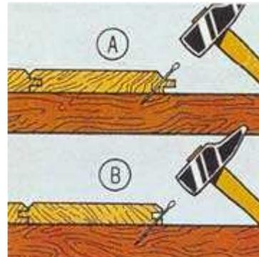
5. Fixez les lambris en les clouant sur les tasseaux. Plantez les pointes en biais dans les languettes A (ou les rainures B).
