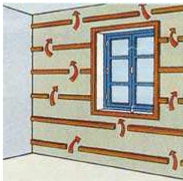
2. N'oubliez pas d'encadrer portes et fenestres. Il est souhaitable de laisser une circulation d'air entre les tasseaux
