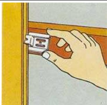
6. Ou bien utilisez la fixation par clips : Engagez la petite languette du clip dans la rainure du lambris. Vous pouvez l'agrafer ou le fixer par un clou.
