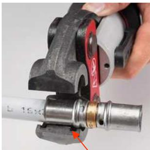
Insérer le raccord dans la mâchoire de la pince avec le bourrelet dans la gorge... gage d'un bon positionnement.
