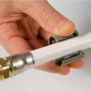
Pour le démonter, placer l'outil sur le tube.
