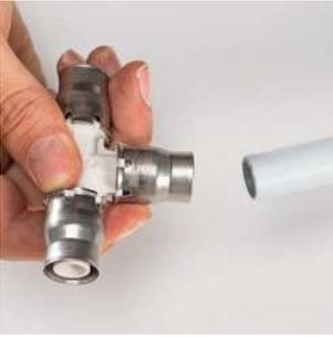
Comme pour les raccords à sertir ou à compression, ébavurer parfaitement le tube avant de l'insérer dans le raccord jusqu'en butée.
