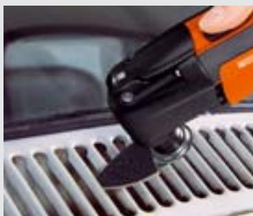
Le doigt de ponçage permet d'accéder facilement aux endroits exigus ou profonds.
