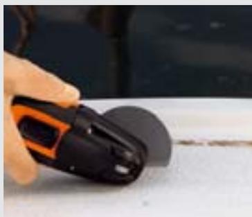
Les lames de scie segment à concrétion carbure se prêtent parfaitement au sciage des coques de bateau en plastique renforcé de fibres de verre ou de carbone. Profitez de coupes de précision (0,5 mm de largeur) nettes et sans endommagement du stratifié.
