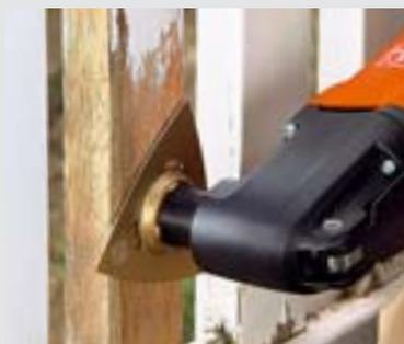
Avec la râpe à concrétion carbure, enlevez totalement les traces d'intempérie, même les plus tenaces, avec une rapidité particulière grâce à un rendement élevé.
