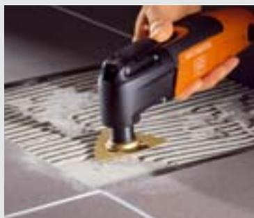
La râpe à concrétion carbure est l'accessoire polyvalent de la pose de carrelage : lissage des colles à carreaux, ponçage des bords du carrelage et rectification plane des fonds.
