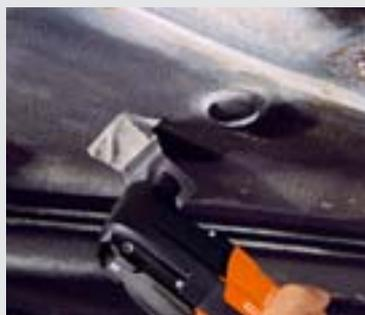
La spatule rigide permet de détacher les protections de bas de caisse et d'autres revêtements tenaces avec une rapidité sans pareil.
