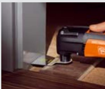
La lames de scie E-Cut font preuve d'une précision et d'une vitesse de coupe extraordinaires lorsqu'il s'agit d'adapter les châssis de porte aux revêtements d'une certaine hauteur et de réaliser des évidements dans les parquets et les stratifiés.
