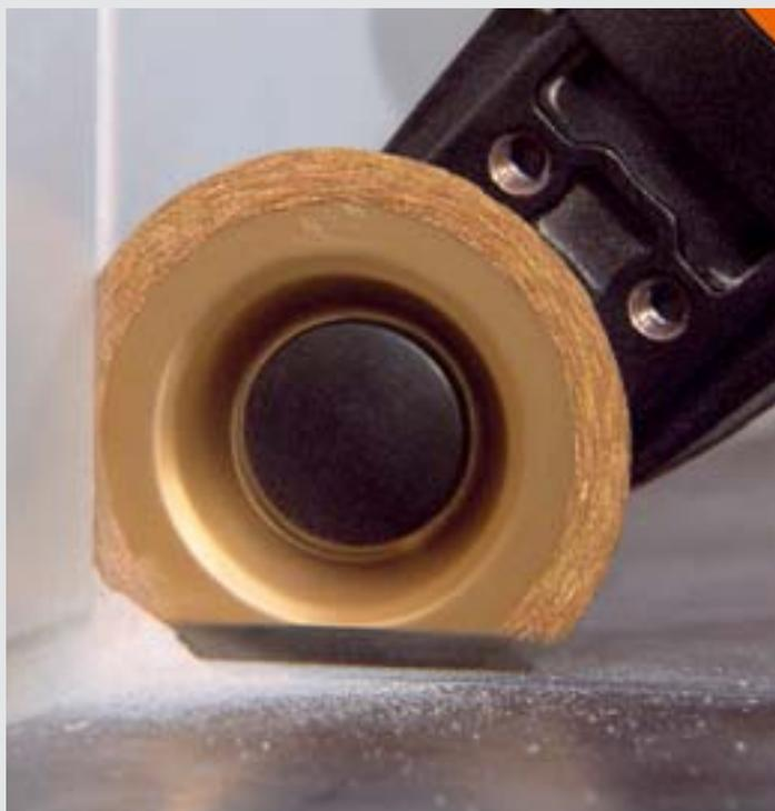
La lame de scie à segment est utilisée pour enlever les joints de carrelage abîmés dans les coins et sur les bords, ce avec précision et sans reprise. La lame de scie segment est disponible en carbure ou en diamant ; la lame diamantée a une durée de vie bien plus élevée et se prête également en extérieur aux matériaux pour joints non gélifs à la résine époxy ou au remplacement de joints.
