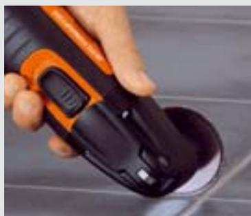
Pour enlever complètement et renouveler les joints de carrelage, la lame de scie diamantée ronde représente la solution la plus économique tant pour ce qui est de la vitesse que de la durée de vie.
