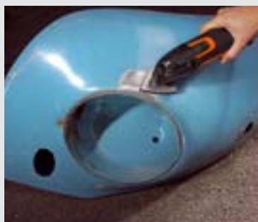
Défauts de peinture, et d'aspect dans des endroits accessibles. Le MULTIMASTER FEIN est dans son élément et garantit un rendement de ponçage élevé et un aspect uniforme de la surface meulée. Vous trouverez la liste des accessoires dans la rubrique **Poncer** à la page 19.
