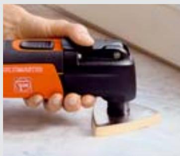
Traitement optimal des rebords de fenêtre en pierre naturelle ou artificielle avec la série d'abrasifs spéciale et un patin de polissage en feutre.
