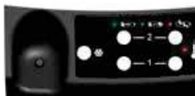
4. Lorsque les LED sont éteintes, le chargeur est prêt à fonctionner.
