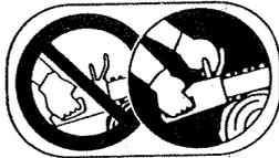
Utiliser la tronçonneuse en se servant des deux mains.
