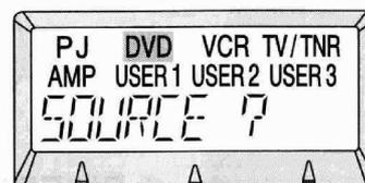
**3** Sélectionner l'appareil que l'on veut régler, puis appuyer sur [ENTER].
