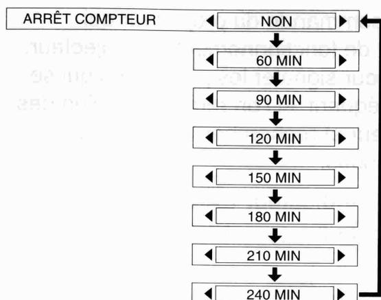
Le projecteur revient en mode d'attente après que la durée qu'on a réglée auparavant est écoulée. On peut régler la durée de 60 minutes à 240 minutes par pas de 30 minutes. Le temps restant sera affiché 3 minutes avant que le projecteur revienne en mode d'attente. Le réglage sera annulé s'il est mis sur "NON" avant que la durée qu'on a réglée auparavant soit écoulée.
