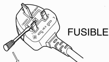
Remplacement du fusible - Ouvrez le logement du fusible à l'aide d'un tournevis et remplacez le fusible.
