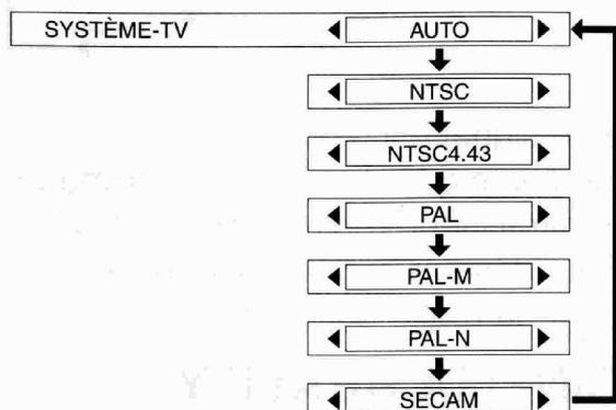
Ceci devrait normalement être réglé sur "AUTO". Si le signal est de qualité inférieure et que le format correct ne peut pas être déterminé automatiquement, changer le réglage manuellement au système TV requis.
