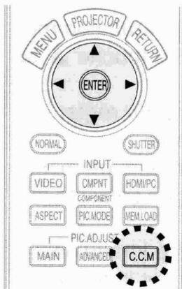
Appuyer sur la touche ▲ ou ▼ pour sélectionner un élément, appuyer sur la touche ◀ ou ▶ pour modifier les réglages, et appuyer sur la touche ENTER pour confirmer.
