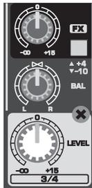
Fig. 2.6 : Les potentiomètres départ d'effet/balance/Level
