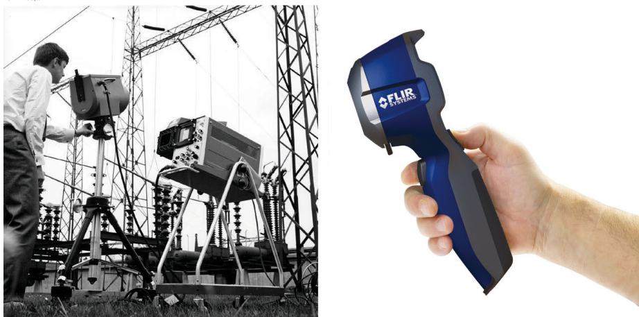
Figure 14.1 A GAUCHE : Thermovision® modèle 661 de 1969. La caméra pesait environ 25 kg, l'oscilloscope 20 kg et le trépied 15 kg. L'opérateur a également utilisé un groupe électrogène de 220 V CA et un récipient de 10 l d'azote liquide. A gauche de l'oscilloscope, on distingue le Polaroid (6 kg). A DROITE : FLIR i5 de 2008. Poids : 0,34 kg, batterie comprise.
