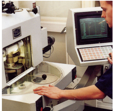
Figure 14.3 GAUCHE : Machine avec outil diamanté ; DROITE : Polissage de lentilles
