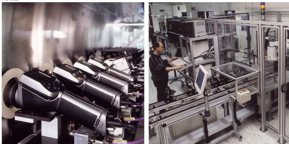
Figure 14.4 GAUCHE : Test de caméras infrarouge en chambre climatique ; DROITE : Robot utilisé pour le test et l'étalonnage des caméras
